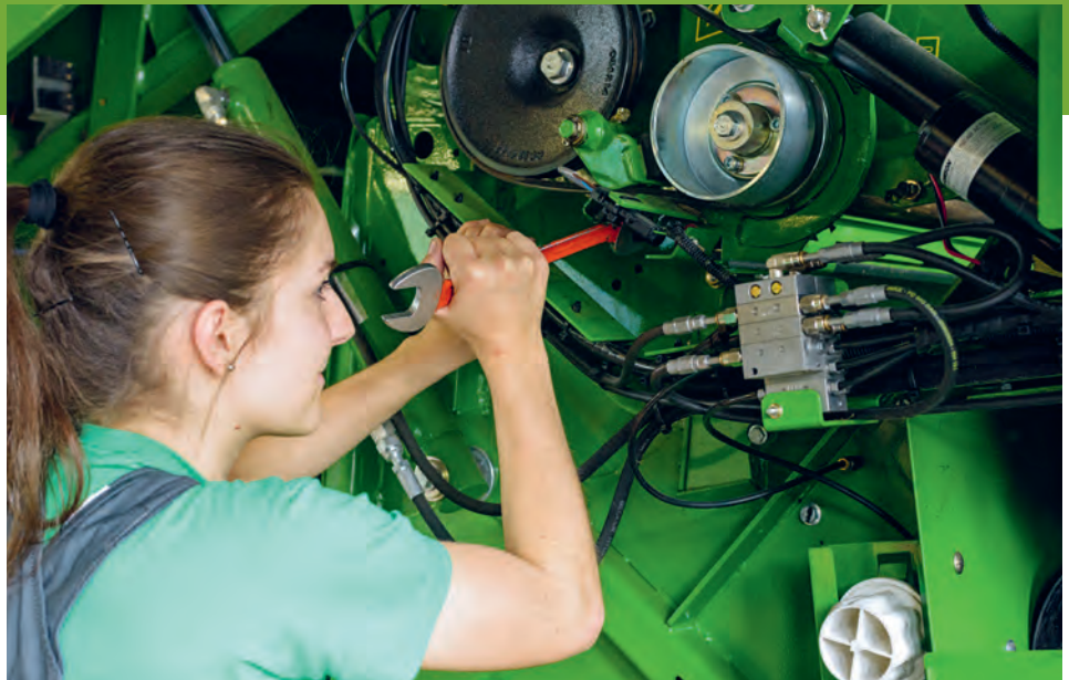
Die Spannung eines Antriebsriemens der Ballenpresse wird eingestellt.
